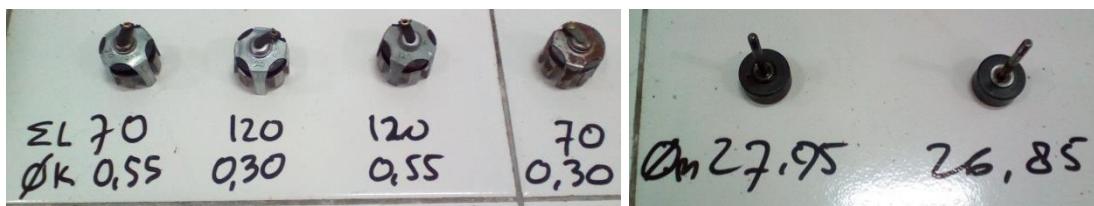
Gambar 3 Variasi diameter, panjang kumparan dan diameter magnet permanen
